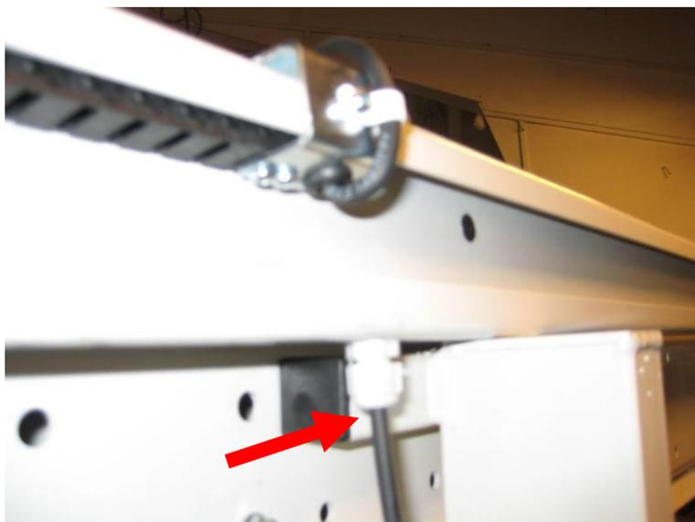
Bohren Sie eine Kabeldurchführung für das Elektrokabel ( $\varnothing$  13 mm) an einer gewünschten Stelle des unteren Randes am C-Profil. Installieren Sie die Zugentlastung und ziehen Sie sie fest.
