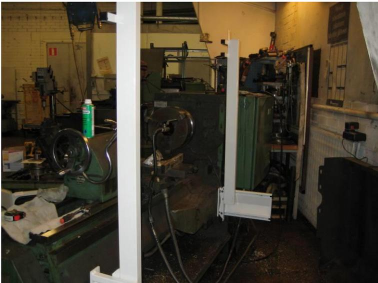
Befestigen Sie Winkeleisen in den Rinnen der senkrechten Pfosten (mit Aufsteckmuttern im Inneren der Pfosten). Montieren Sie die Pfosten an die Horizontalträger mithilfe der im C-Profil befindlichen Aufsteckmuttern.
