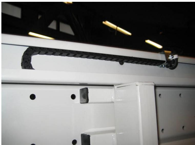
Überprüfen Sie die Funktion der Energieübertragungskette auf der gesamten Schienenlänge.
