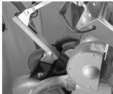
Befestigung mithilfe der Zusatzkonsole
